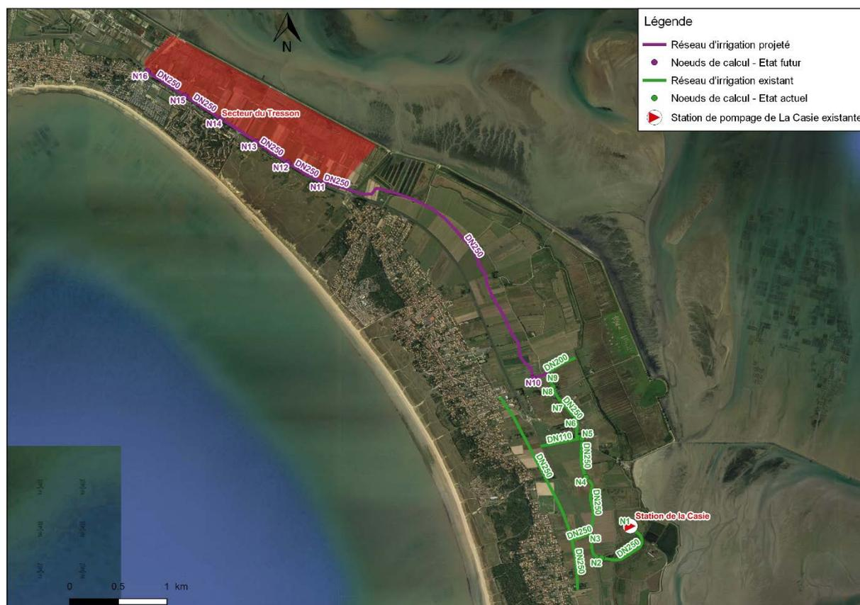
Figure 13 : Tracé du réseau d'irrigation projeté et nœuds de calcul pour l'état futur – Variante n°2
