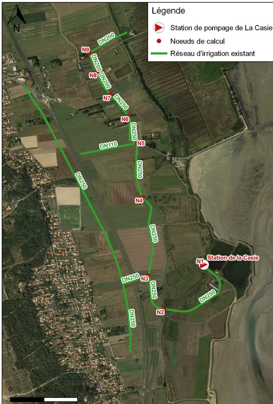
Figure 7 : Vue en plan des nœuds de calcul pour le diagnostic hydraulique
