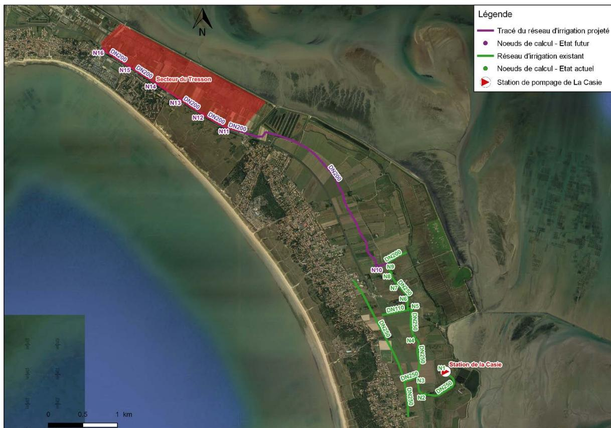
Figure 12 : Tracé du réseau d'irrigation projeté et nœuds de calcul pour l'état futur – Variante n°1
