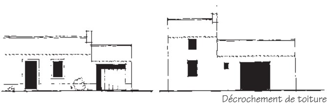
Décrochement de toiture
